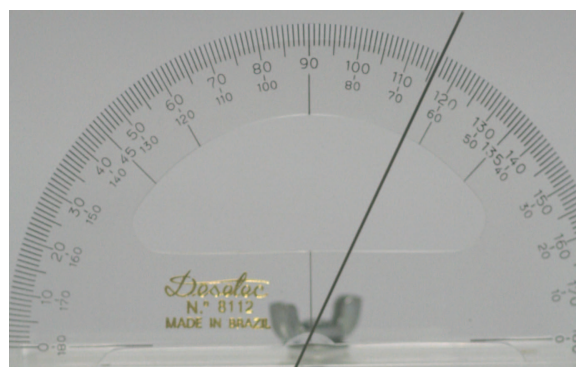
Figura 5 - Intersecção do segmento vertical do arco e o eixo zero do transferidor.
