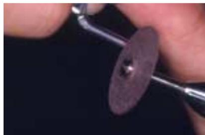
**FIGURA 9** - Corte do tubo com disco de carborundo.
