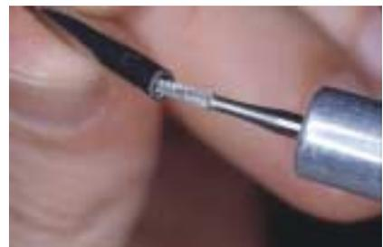
**FIGURA 10** - Ampliação da luz do tubo para o perfeito deslizamento do pistão.
